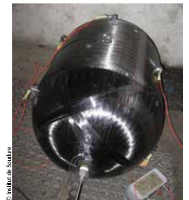
↑ Pour tester la bouteille composite, l'IS propose un contrôle acoustique.
